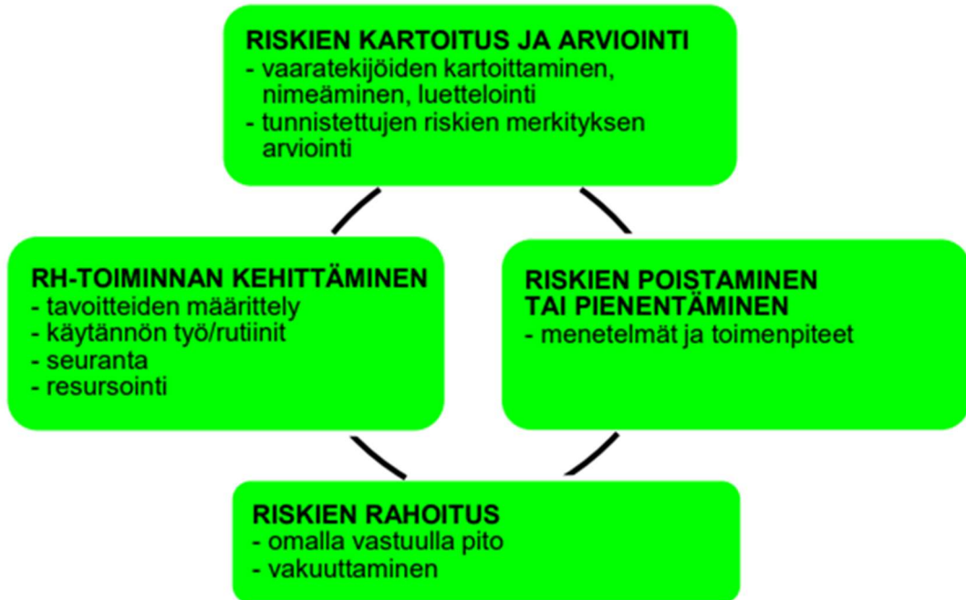
Kaavio 1. Suunnitelmalliseen riskienhallintaan kuuluu riskien kartoitus ja arviointi, riskien poistaminen tai pienentäminen, riskien rahoitus sekä riskienhallintatoiminnan kehittäminen.
